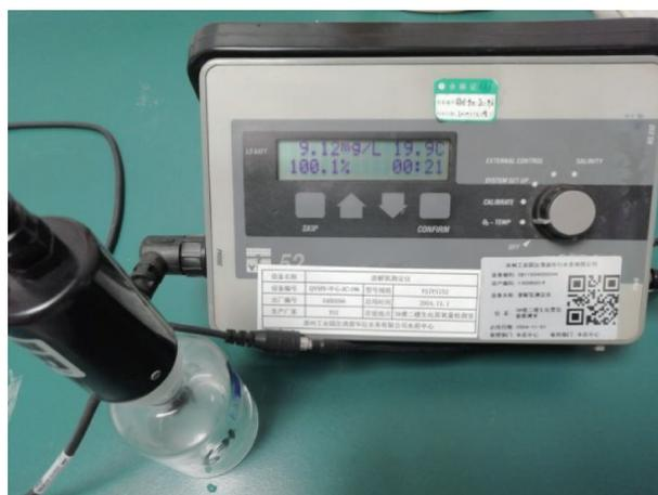
图 1 溶解氧电极校准
