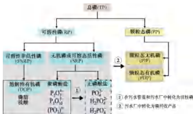
图2 磷在水体中的形态与污水厂中磷的转化
