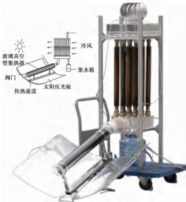
图 6 太阳能驱动的空气取水装置<sup>[12]</sup>
