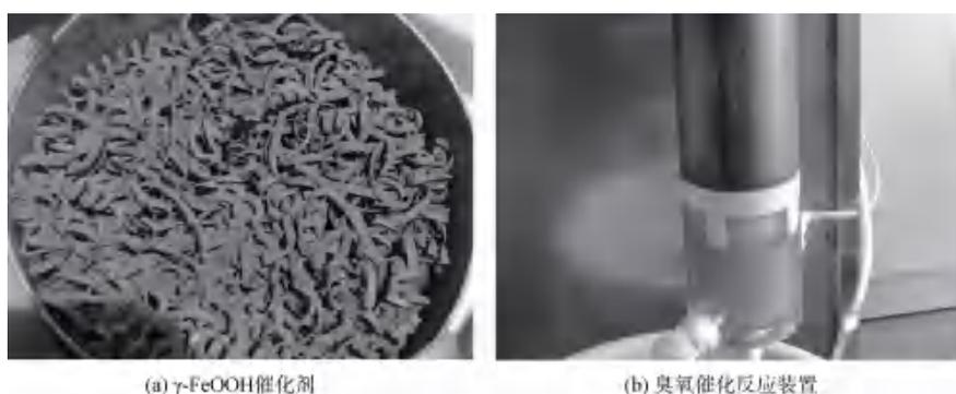
图2  $\gamma$ -FeOOH 催化剂与臭氧催化反应装置
