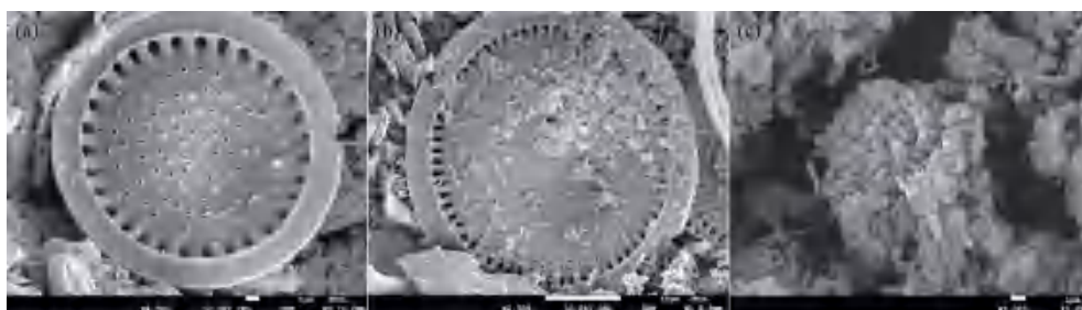
图3 (a)微生物载体、(b)复合粉末载体投加前与(c)复合粉末载体投加后 SEM
