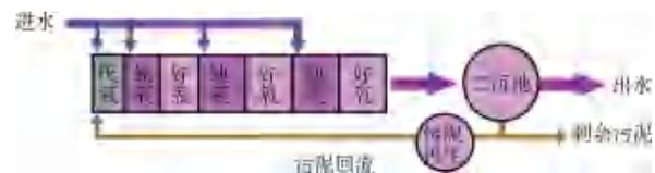
图 1 多级 AO 工艺流程
