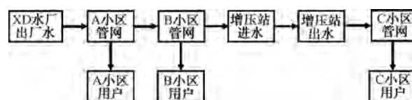
图 1 供水管网系统中的取样点
