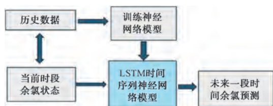
图 5 串级 LSTM 模型应用系统
