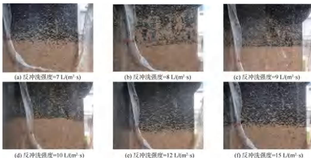
图 3 水反冲洗强度对滤料混层的影响
