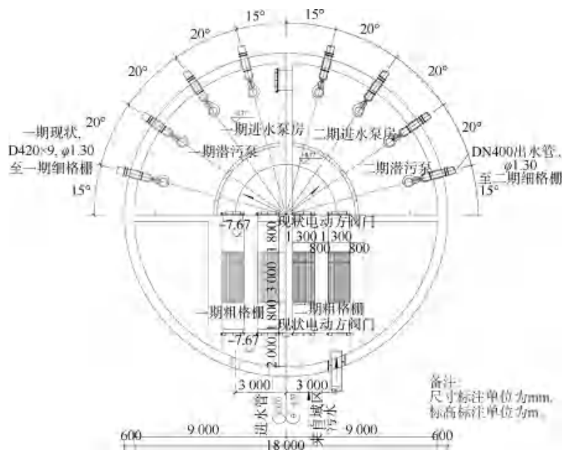
图1 ST污水处理厂粗格栅及提升泵房改造
