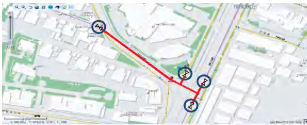
图7 GIS中生成关阀止水方案
