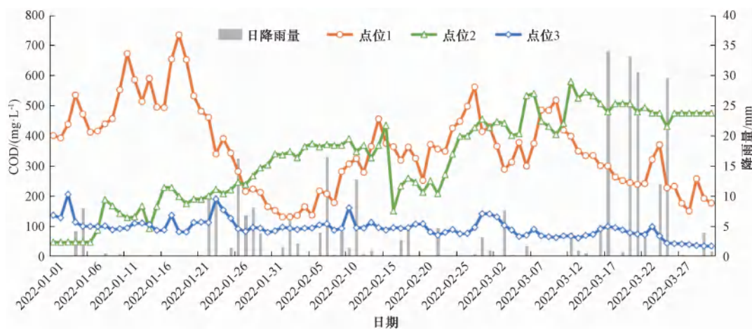
图 7 主管监测点水体 COD 浓度随降雨量变化情况
