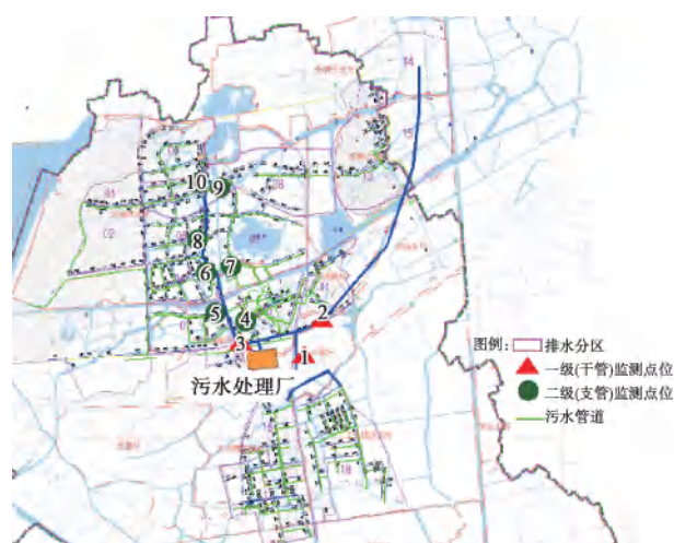
图 6 排水分区及 COD 监测设备布置
