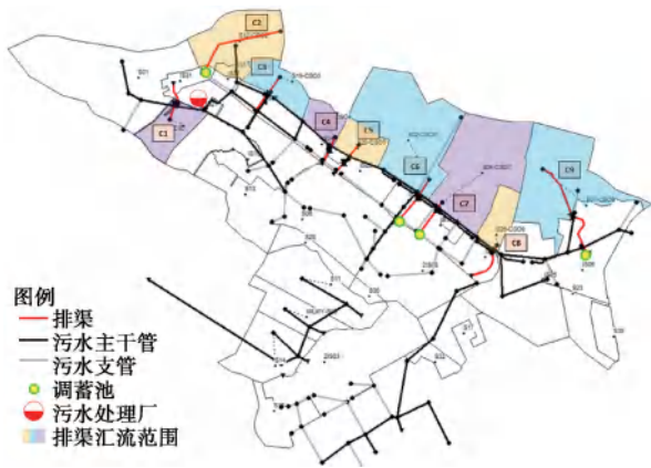
图 2 研究区域污水系统模型概化图 Fig. 2 Generalized Model Map of Sewage System in the Research Area
