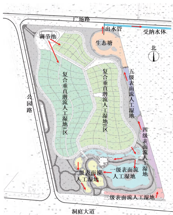
图2 人工湿地总平面布置
