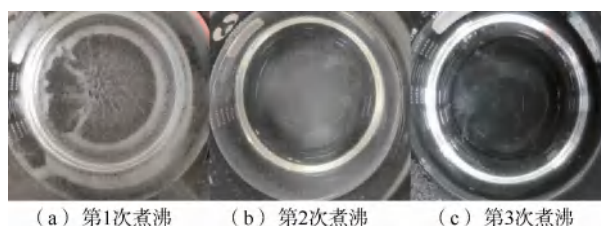
图 2 地下水原水 3 次煮沸后水垢析出 Fig. 2 Scale Formation of Raw Groundwater after Boiled Three Times
