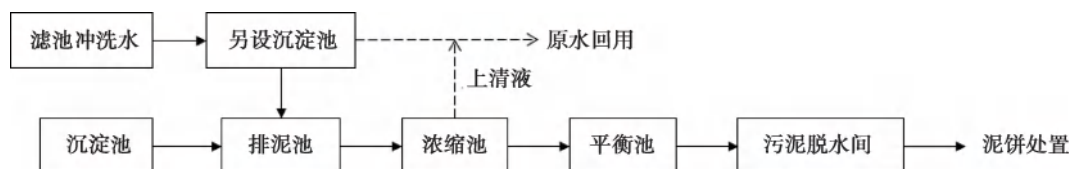
图2 滤池反冲洗水和沉淀池排泥水分类处理工艺流程
