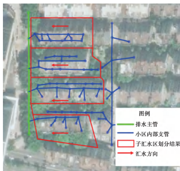
图3 基于排水管网溯源分析法原理概化图
