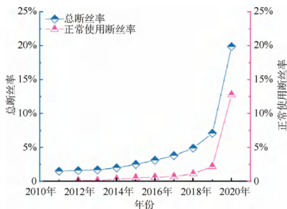
图5 MBR膜断丝率增长趋势
