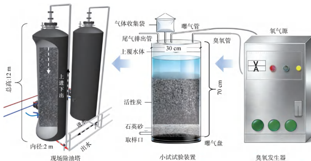
图1 活性炭除油塔试验装置
